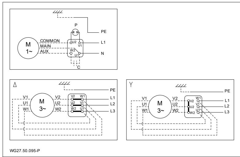
Drehstrommotoren 230/400 V werden bei 230 V im Dreieck und bei 400 V im Stern angeschlossen.
