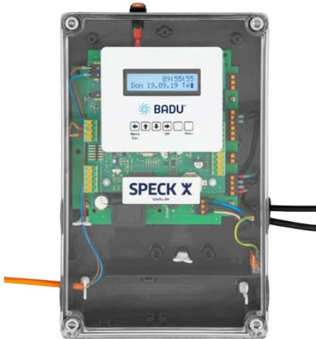
^ Schaltkasten zur Anbindung an Pumpensteuerung
